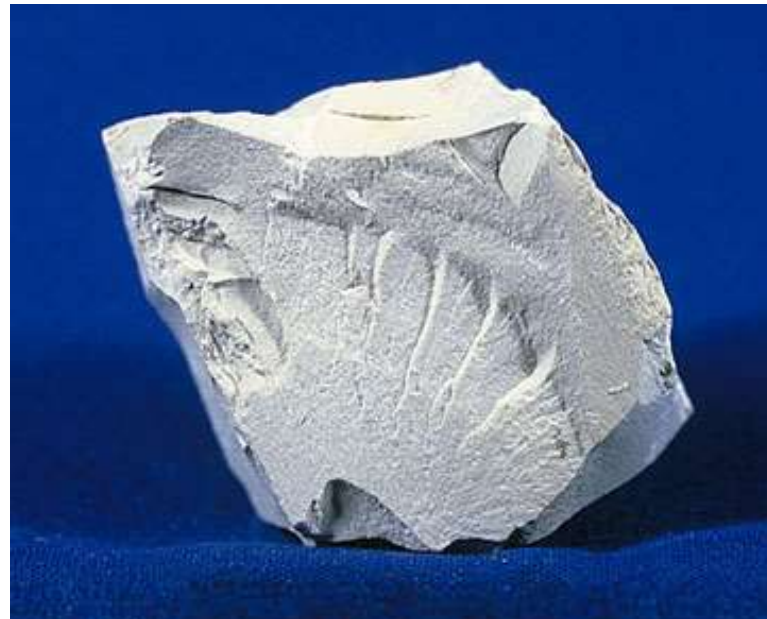
Figuur 3. Het mineraal kaolinit. De chemische formule van kaolinit is \text{Al}_2\text{O}_3 \cdot 2\text{SiO}_2 \cdot 2\text{H}_2\text{O} . Door verhitten wordt de aluminiumsilicaat omgezet in meta-kaolien: het kristalwater wordt eruit gestookt (foto: Wikimedia Commons)
